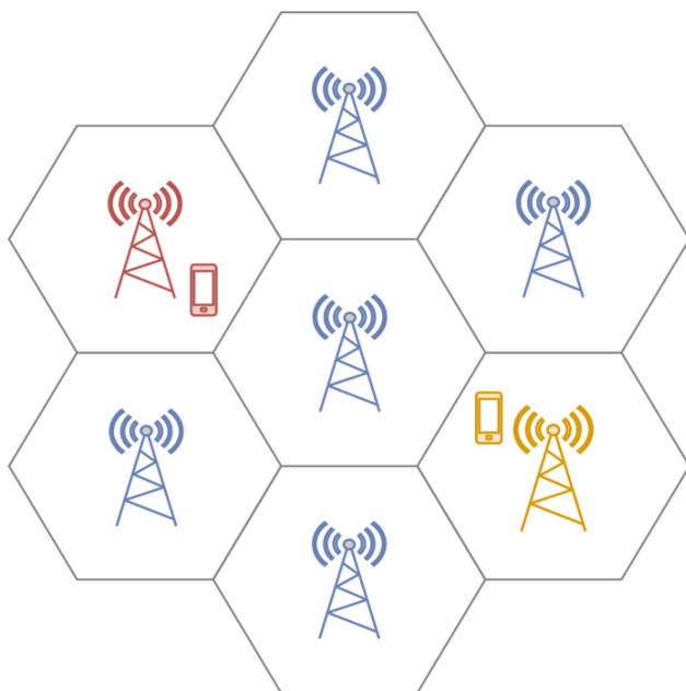
Abbildung 1: Vereinfachtes Schema einer wabenförmigen Aufteilung von Funkzellen in einem Mobilfunknetz.
